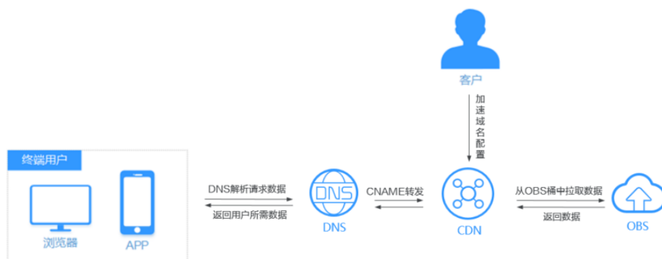
图 5-4 视频点播加速架构图
