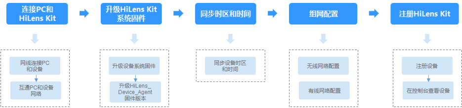
图 11-8 智能边缘系统注册设备流程
