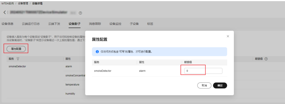
图 3-83 设备影子-属性配置 alarm
