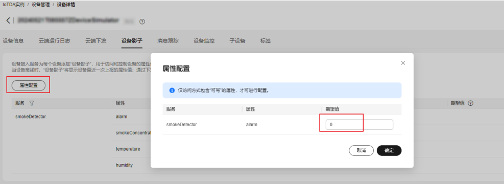
图 3-10 设备影子-属性配置 alarm
