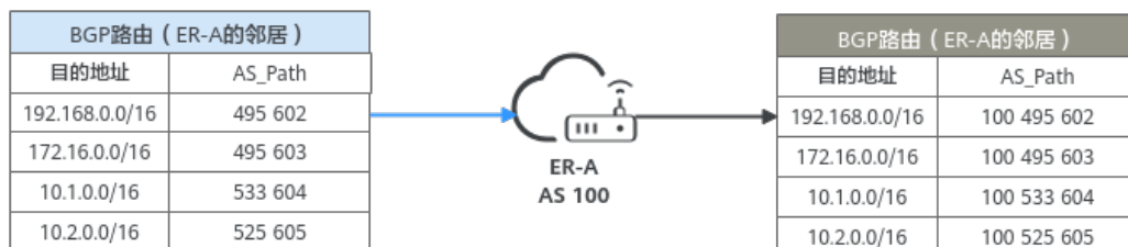
图 8-3 AS_Path 原理图示
