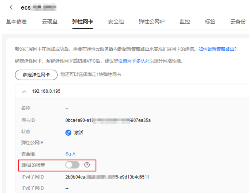
图 4-12 关闭网卡的“源/目的检查”功能
