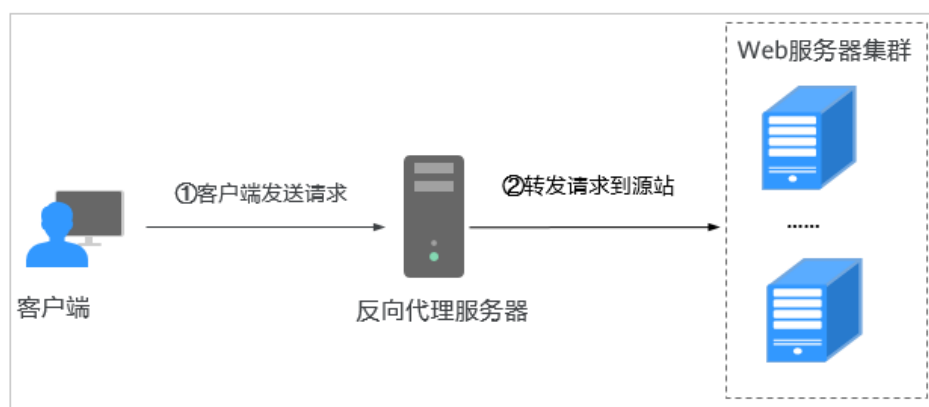
图 1-3 Nginx 转发原理
